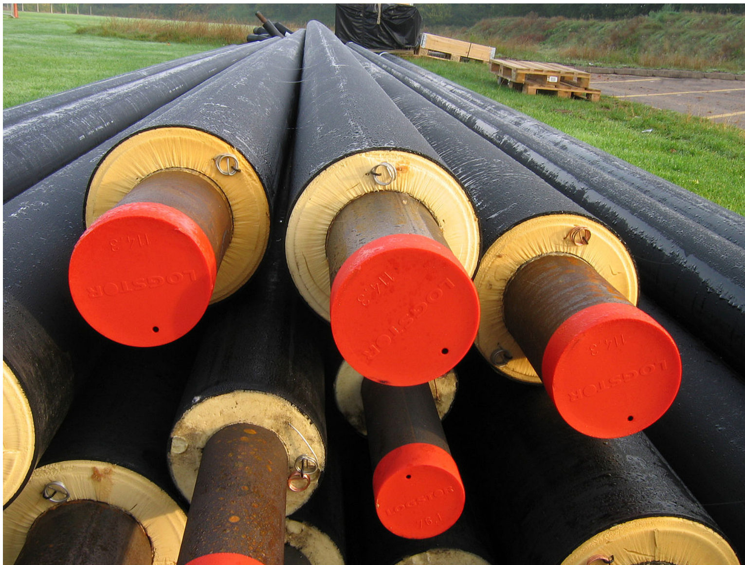
Слика 6.4 Предизоловане цеви
